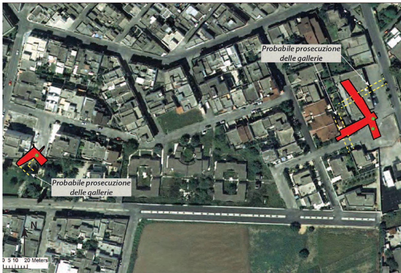
Fig. 5 – Proiezione in pianta su ortofoto del 2006 della Regione Puglia dei rilievi tridimensionali delle due cave ipogee rilevate nel centro urbano di Cutrofiano. Con le linee tratteggiate in giallo sono indicate le aree in cui si presume l'estensione delle gallerie delle cave ipogee.
