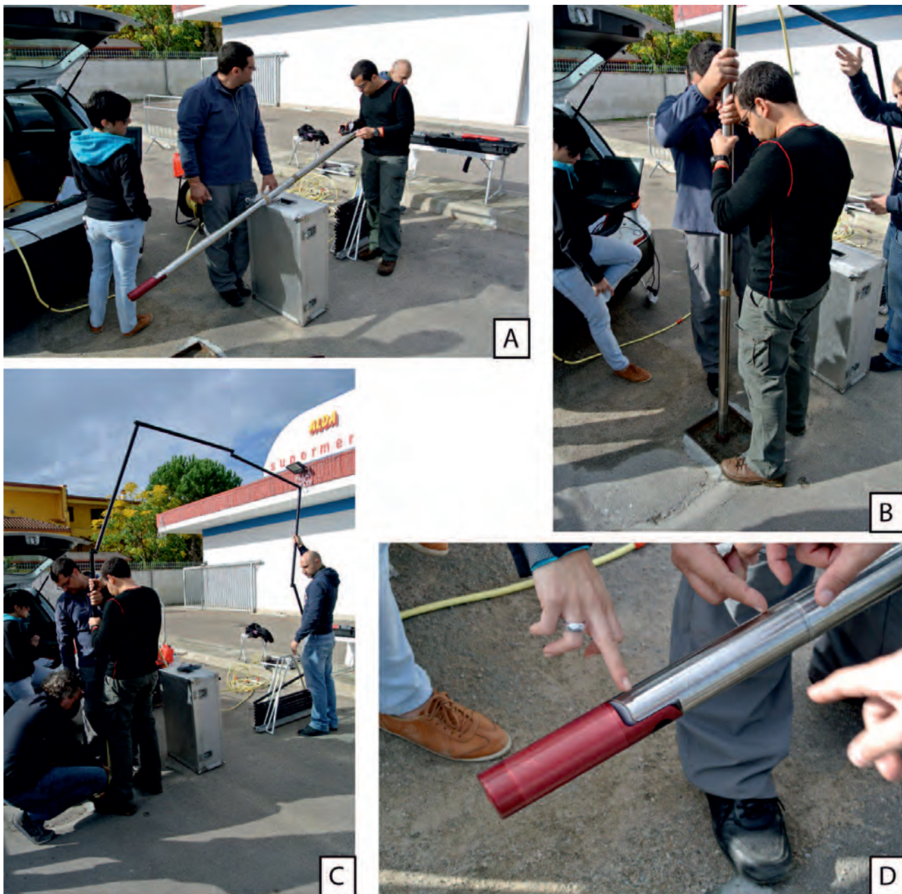
Fig. 2 - Rilievo con laser scanner da foro. A) preparazione dello strumento e acquisizione dell'azimuth con una bussola; B) fase iniziale dell'inserimento del laser scanner nel foro di sondaggio; C) dispiegamento della sonda nel foro di sondaggio con aste snodabili; D) dettaglio della sonda montata alla testa dello strumento, sono indicate le parti dello strumento che ruotano durante la scansione.
