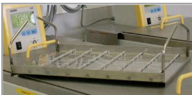
Figura 4.21 – Dosimetri CR39 fissati nell'apposita struttura a molle.
