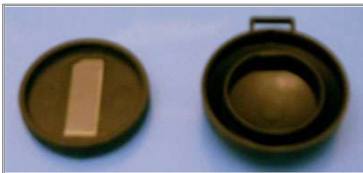
Figura 4.20 – Dosimetro CR39 aperto.
