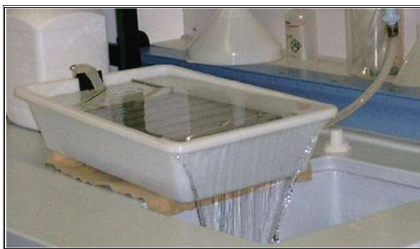
Figura 4.23 – Lavaggio dosimetri CR39 in acqua corrente.
