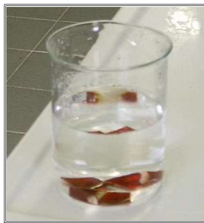
Figura 4.11, 4.12 – Lavaggio LR115 successivo all'attacco chimico: rispettivamente, a partire dalla foto di sinistra, in acqua corrente e in acqua distillata.
