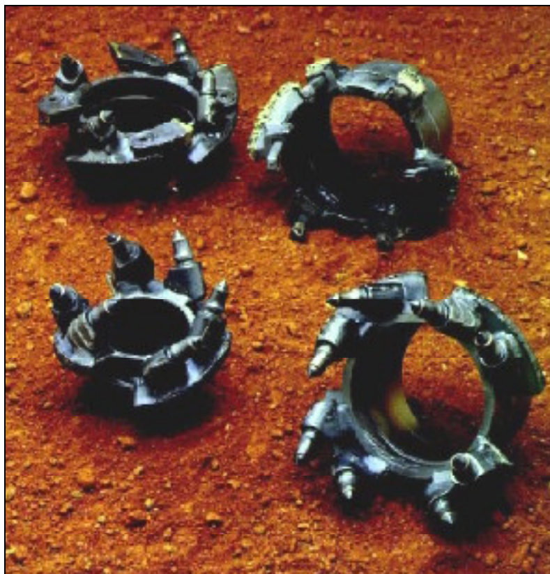
Fig. 21 – Teste fresanti (da Boart Longyear)
