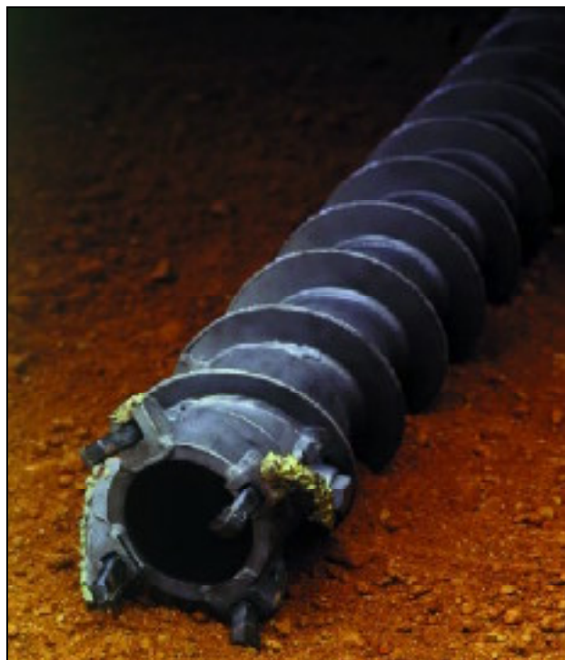
Fig. 20 – Trivella ad asta cava (da Boart Longyear)
