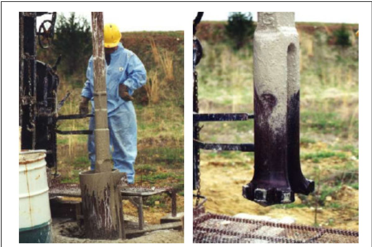
Fig. 27 – Tecnica di perforazione “Cable tool” (da USGS)
