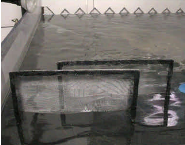
Figura 2.7: Telai per la dissipazione del vortice
