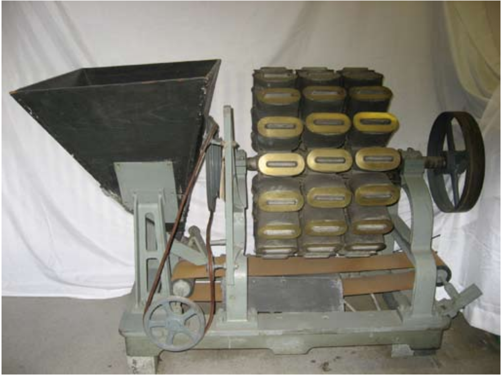
Fig. 5 - Prototipo dell'elettrocernitrice magnetica ideata da Quintino Sella. Il macchinario, rinvenuto nel 1902 presso la miniera di Traversella, è attualmente conservato al Politecnico di Torino (Archivio fotografico Michelangelo Gilli).
