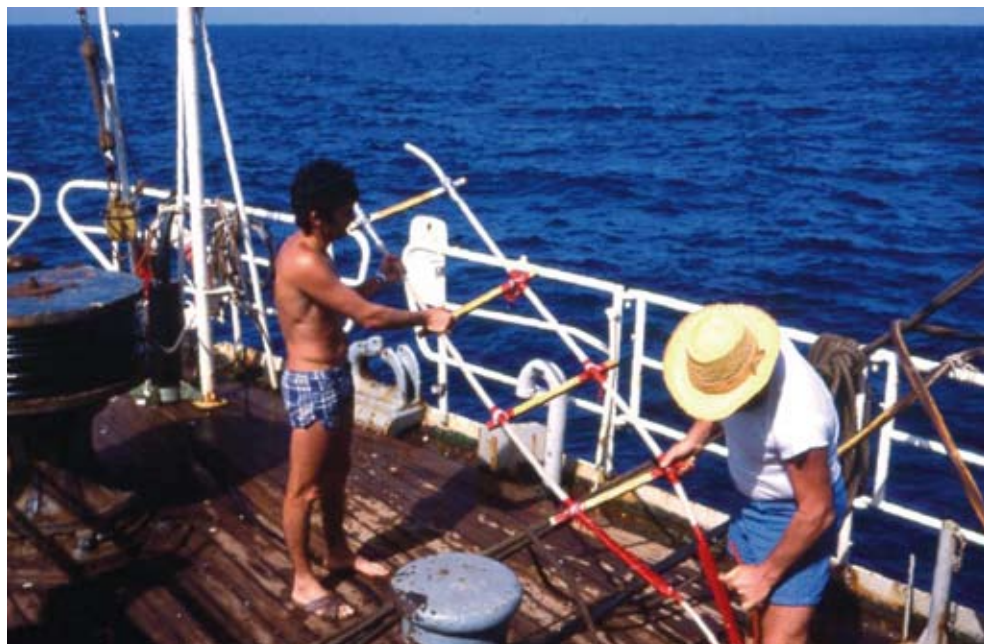
Fig. 6 - Sistemazione degli elettrodi del sistema di prospezione sismica "Sparker" a bordo della N/O Salernum nel 1979).
