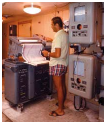
Fig. 2 - Le impressionanti dimensioni del PGR (Precision Graphic Recorder), il primo ecografo che permetteva di agire sul segnale acustico e di registrarlo su carta elettro-sensibile (N/O Bannock 1969).
