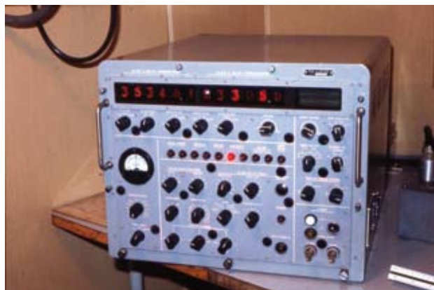
Fig. 1 - Il ricevitore del sistema LORAN (Long Range Navigation System) a bordo della N/O Bannock nel 1968. Il sistema, sviluppato dal Dipartimento della Difesa USA durante la seconda guerra mondiale, permise di superare la navigazione astronomica per ottenere il punto in mare aperto, prima che lo stesso Dipartimento introducesse il GPS.
