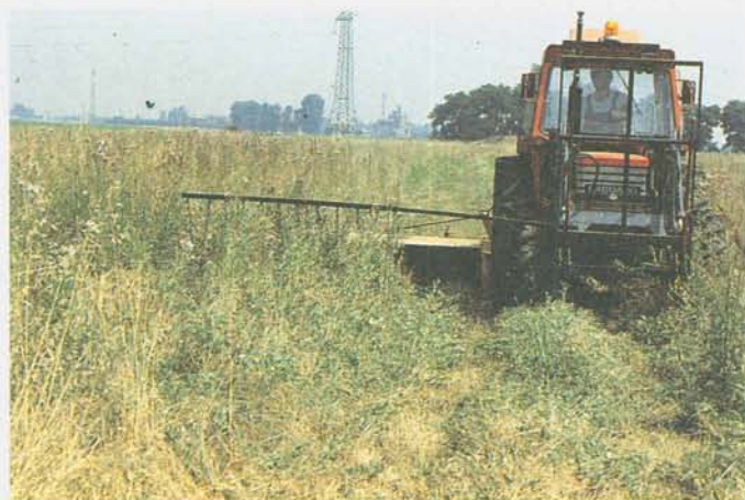
Barra d'involo montata su macchina falciatrice
