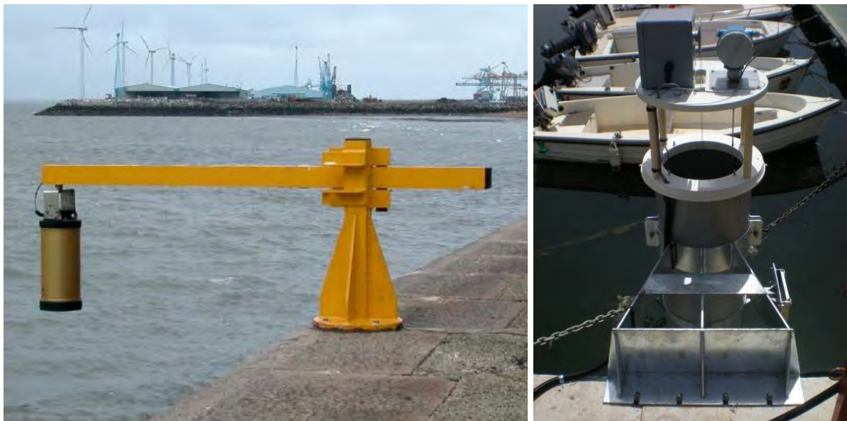
Figura 2.8 – A sinistra: idrometro radar in fase di test presso il porto di Liverpool (Gran Bretagna). Fonte: IOC (2006), “Manual on Sea Level – Measurement and Interpretation, Volume IV, Manuals and Guides 14”. A destra: mareografo a microonde in fase di installazione presso il porto di Sciacca. Fonte: ISPRA – Rete Mareografica Nazionale.
