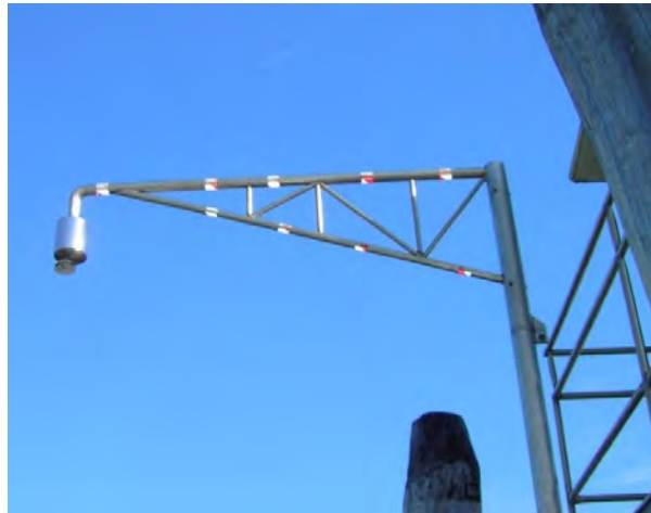
Figura 2.6 – Ondametro ad ultrasuoni montato all'esterno della stazione di Murano (ISPRA - Rete Mareografica della Laguna di Venezia e del litorale Nord-Adriatico).
