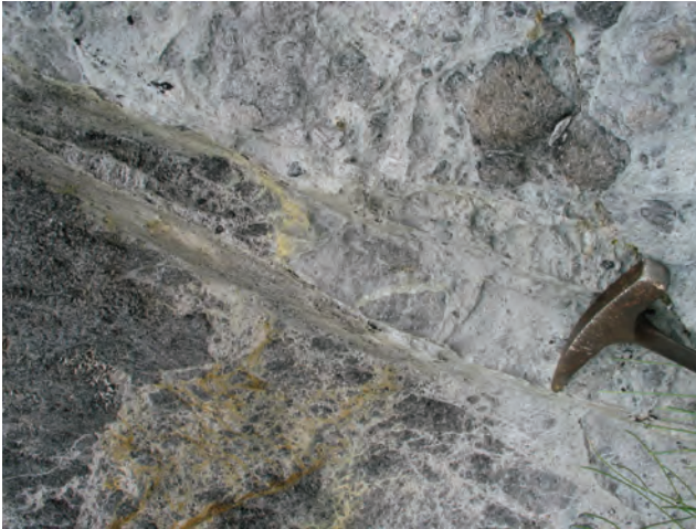
Fig. 5 - Shear band in hyaloclastite accommodating deformation and fluid escape. - Shear band in ialoclastite che accomodano la deformazione e la fuoriuscita dei fluidi.
