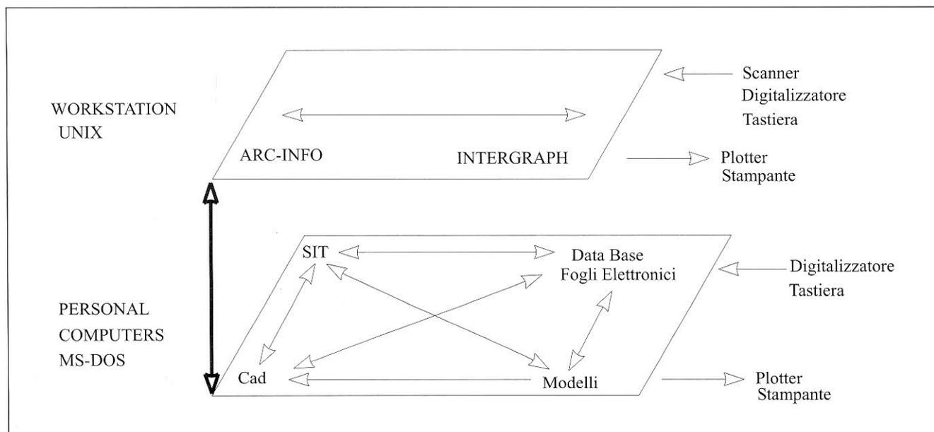
Fig. 3. – Schema della struttura hardware e software utilizzata.
