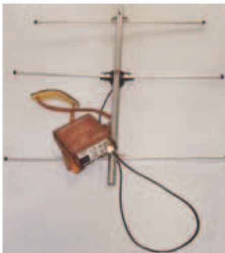
Figura 4.14 - Un tipico apparato per il radiotracking , costituito da un'antenna direzionale portatile e da un ricevitore radio (Foto A. Martinoli).
