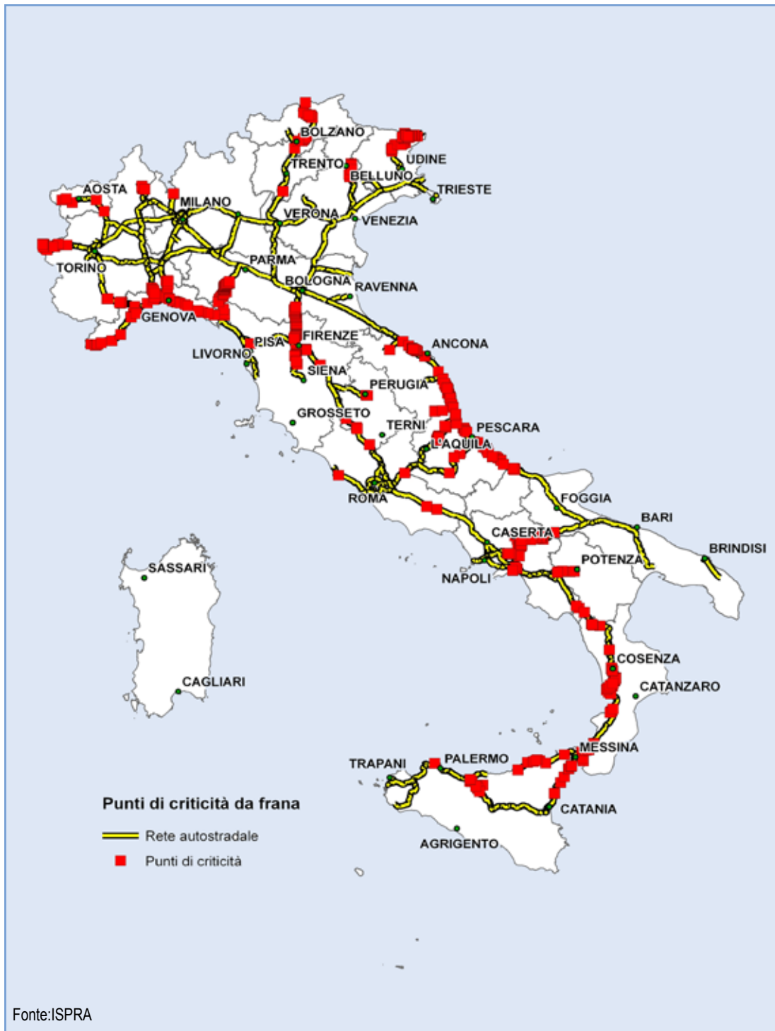
Figura 14.18: Punti di criticità da frana lungo la rete autostradale
