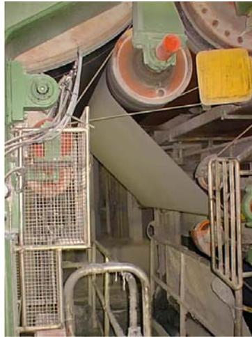
*Fig. 5 I cilindri della zona presse*
