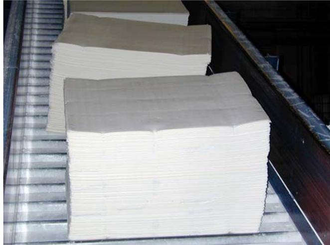
*Fig. 3 Nastro trasportatore della cellulosa al pulper*
