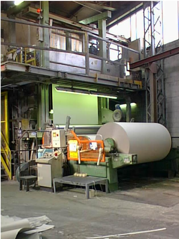
*Fig. 6 Uscita dalla macchina continua della carta che viene arrotolata*
