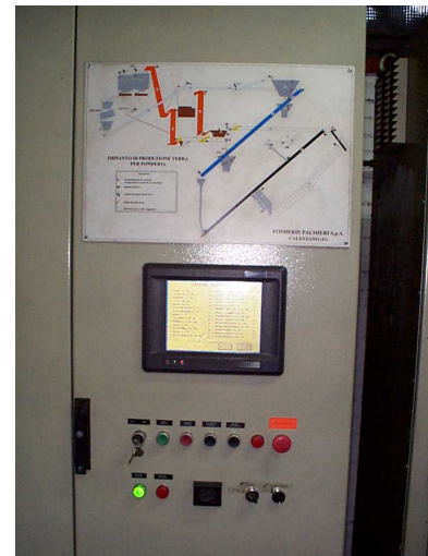
Foto 4.2.1 Quadro di controllo nastri trasportatori.
