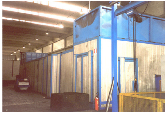
Foto 4.3.2 Cabina – tunnel per la distaffatura delle staffe provenienti dalla linea di formatura automatica
