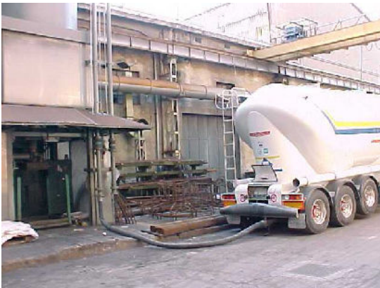
Foto 4.1.1 Scarico pneumatico di sabbia silicea da autocisterna a silos.
