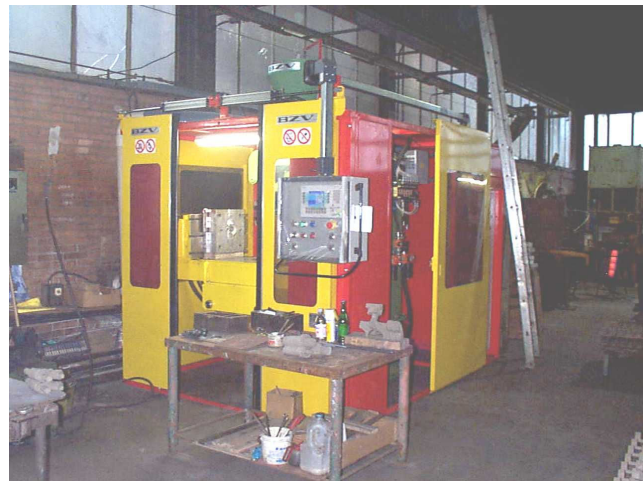
Foto 4.2.1 macchina spara anime cold box, automatica, chiusa e aspirata.
