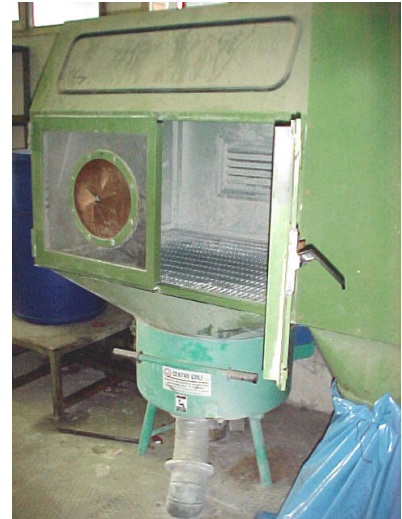
Foto 4.2.1 Sistema chiuso per la apertura manuale dei sacchi di materiale in polvere dotato di aspirazione e trasporto pneumatico.
