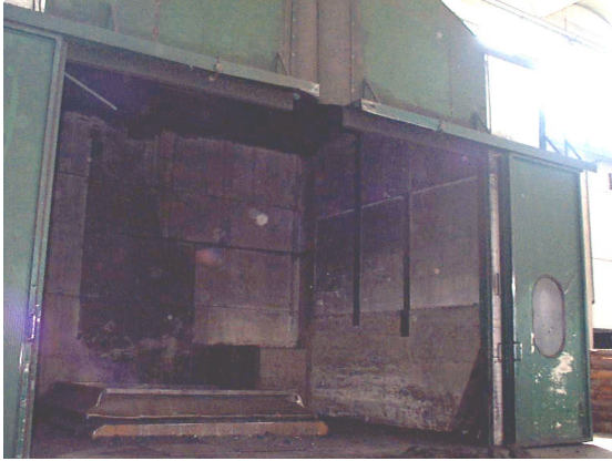
Foto 4.4.1 Griglia vibrante distaffatrice per staffe grandi, segregata tramite cabina insonorizzata.
