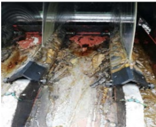
Figura 45. Disco di sinistra poco efficiente nella separazione oli
