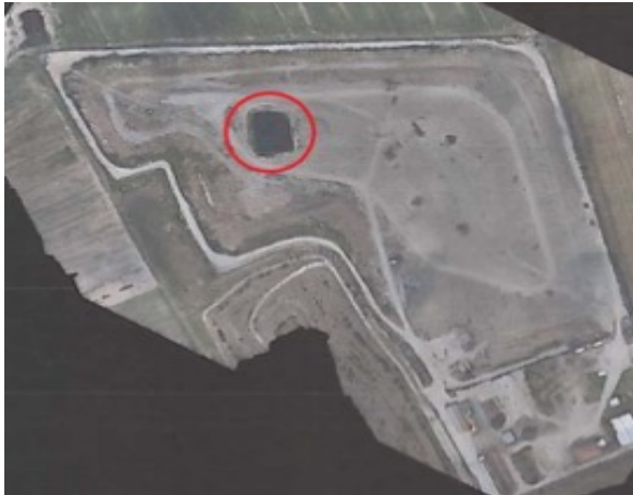
Figura 18. Ortofoto del 2018 con l'invaso temporaneo realizzato sul corpo rifiuti (cerchiato in rosso)
