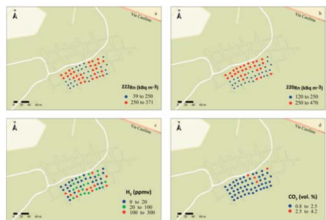
Fig. 38 - Mappe a classi di colori delle concentrazioni di ^{222}\text{Rn} (a), ^{220}\text{Rn} (b), \text{CO}_2 (c) e \text{H}_2 (d).
